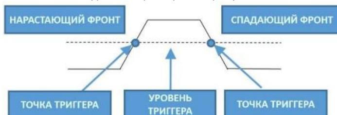
Нарастающий фронт триггера: система триггера определяет амплитуду сигнала в процессе нарастания.
