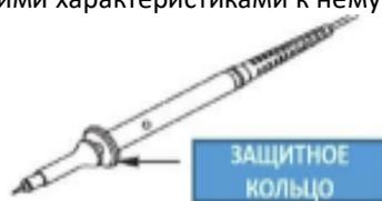
При подключении пробника к осциллографу в первый раз рекомендуется проверить компенсацию как указано ниже. Использование некомпенсированного пробника или пробника, представляющего отклонение компенсации, может привести к искажению результатов измерений. Для настройки компенсации пробника, пожалуйста, выполните следующие шаги:
