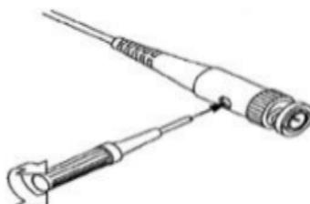
Настройки коэффициента ослабления пробника влияют на коэффициент вертикального отклонения. Перед началом работы необходимо убедиться, что коэффициент ослабления, установленный на самом пробнике, соответствовал коэффициенту ослабления, выбранному в меню осциллографа.
