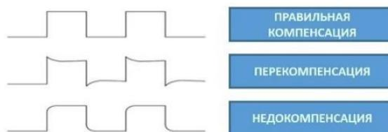
3. При необходимости, для дополнительной настройки компенсации, используйте специальный регулировочный винт, расположенный около разъема пробника. Для этого используйте специальную отвертку, которая идет в комплекте с пробником, или другой немаetalлический инструмент. Способ настройки указан на рисунке ниже.
