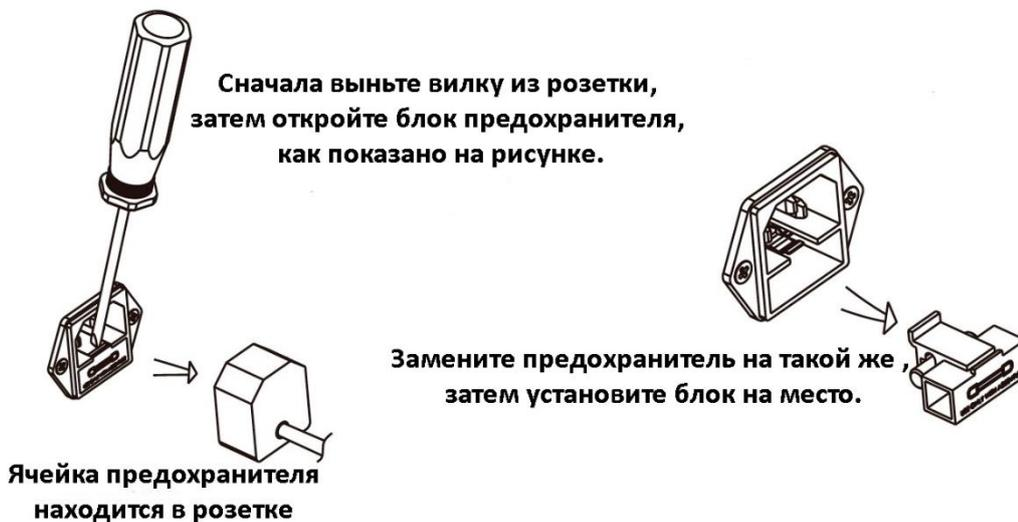
Для эффективной защиты от перенапряжения необходимо заменить предохранитель на такой же, с такой же маркировкой. Перед заменой предохранителя необходимо отключить питание и вынуть шнур питания из розетки.
